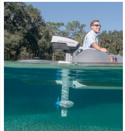
Der Unkrautfräser ist so konstruiert, dass er nahtlos mit der Motorwelle rotiert und effektiv Unkraut, Seile und andere Ablagerungen durchschneidet, bevor sie sich um die Welle oder den Propeller legen können. Dies sorgt für einen reibungslosen Betrieb, reduziert Ausfallzeiten und schützt Ihr Antriebssystem vor Verhedderungen in schwierigen Gewässern. 90 2343
